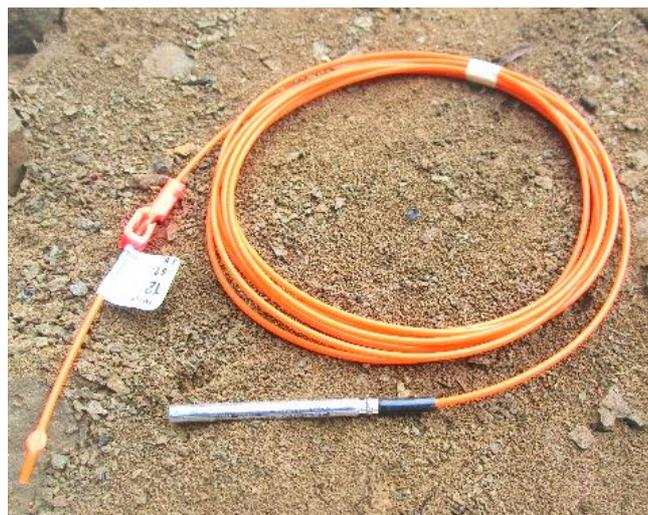
En uno de sus extremos está sellado por ultrasonido y en el otro extremo ensamblado con el Fulminante de retardo. El color de la Manguera Fanel UV permite identificar la escala de tiempo de retardo del Fanel UV, así tenemos que: Para el periodo corto la Manguera Fanel UV es de color naranja (MS); para el periodo largo la Manguera Fanel UV es de color amarillo (LP).
