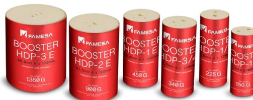
Son utilizados para iniciar explosivos insensibles o agentes de voladura de tipo Slurries, Anfo y Nitrocarbonitratos, donde un Fulminante Común o el poder explosivo de un Cordón Detonante no los activa. Estos se usan en la voladura de taladros de diferentes diámetros en las minas de tajo abierto, canteras y eventualmente en minería de subsuelo.
