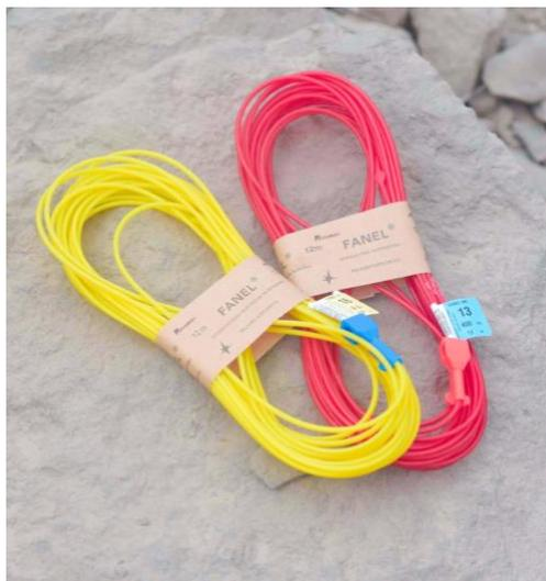
En uno de sus extremos está sellado por ultrasonido y en el otro extremo ensamblado con el Fulminante de retardo. El color de la Manguera Fanel permite identificar la escala de tiempo de retardo del Fanel, así tenemos que: Para el periodo corto la Manguera Fanel es de color rojo o naranja (MS); para el periodo largo la Manguera Fanel es de color amarillo (LP).
